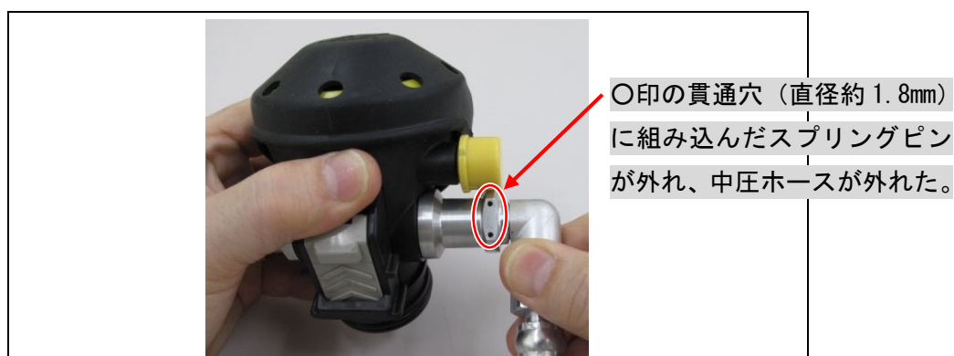
図2. 不具合箇所（プレッシャデマンド弁）
