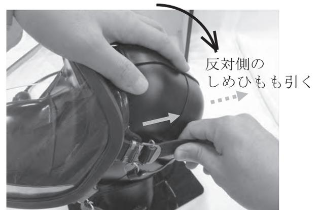
図 39 しめひもの締め付け
