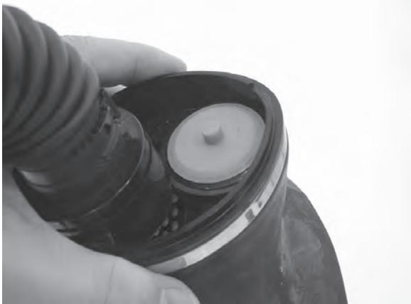
図 22 呼気弁カバーを外した状態
