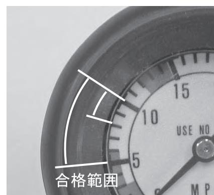
図 18 合格範囲（圧力指示計の示度）
