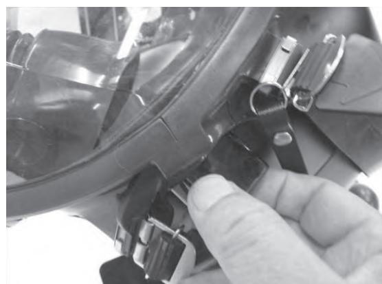
図 44 流量点検パイプの挿入
