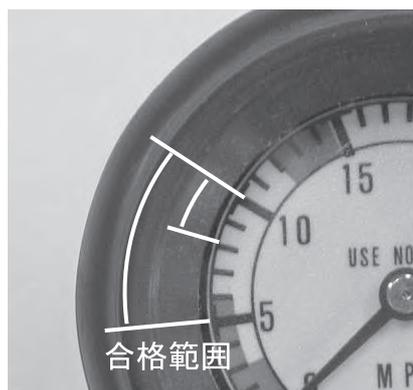
図 18 合格範囲（圧力指示計の示度）
