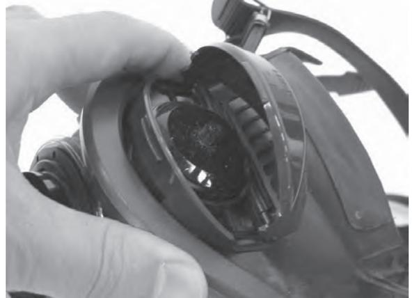
図 24 呼気弁カバーを外した状態
