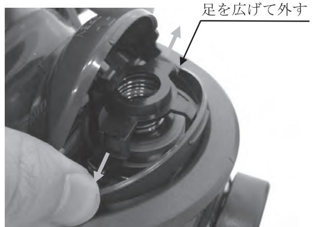
図 30 ばね枠を外す
