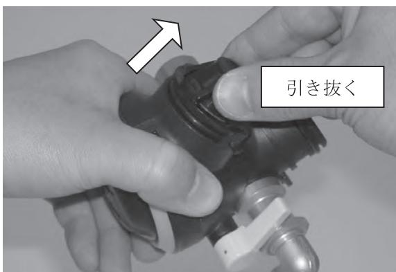
図35 呼気弁セットを外す
