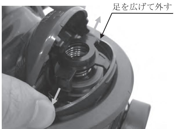
図 30 ばね枠を外す
