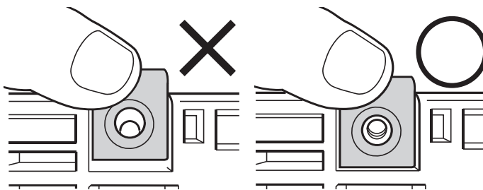
図 87 ねじ穴が合っていない場合 図 88 ねじ穴が合っている場合
