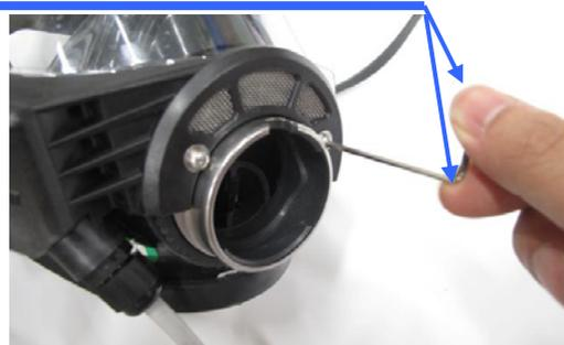
図4 5. ねじの締め付け
