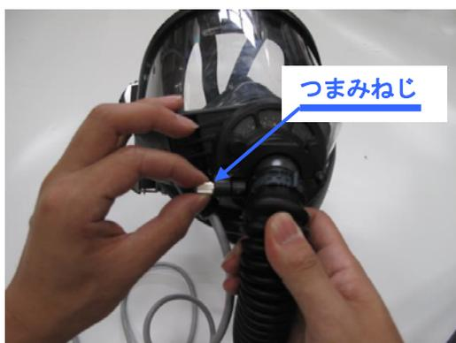
図31. 反時計方向に回す
