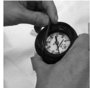
第27図 圧力指示計にかける
