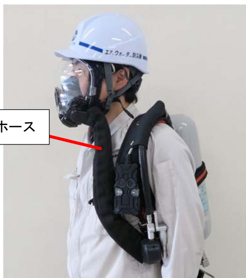
図 45. 立坑進入キーを取り外した状態で背負う時
