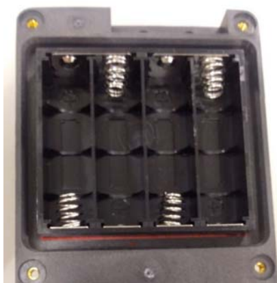
図4-3. 電池取り付け部
