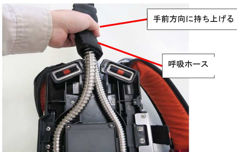
図 43. 呼吸ホース取り外し
