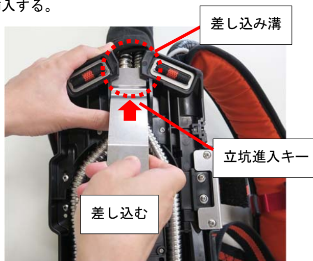
図 6. 立坑進入キー差し込み
