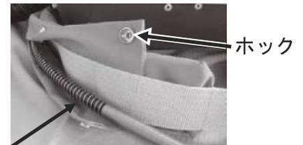
圧力指示計導気管③① 図-11
