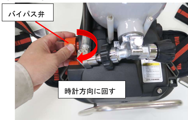
図 22. バイパス弁確認
