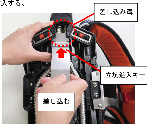
図 6. 立坑進入キー差し込み
