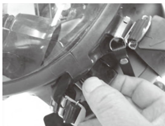
図 44 流量点検パイプの挿入
