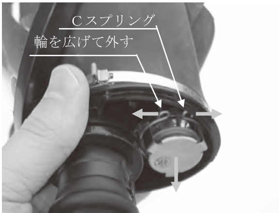
図 27 ばねカバーを外す
