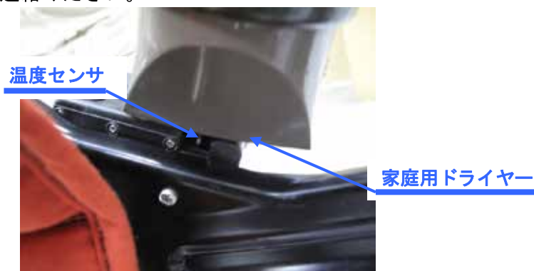
図11. 温度警報の動作確認
