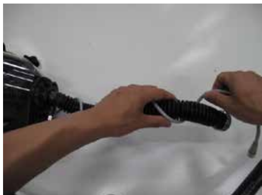
図 4 0. 残りのケーブルの巻き付ける
