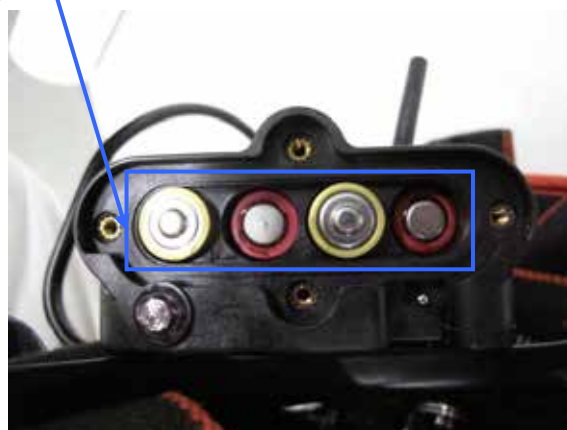
図20. ケース側の極性マークと電池極性の並び
