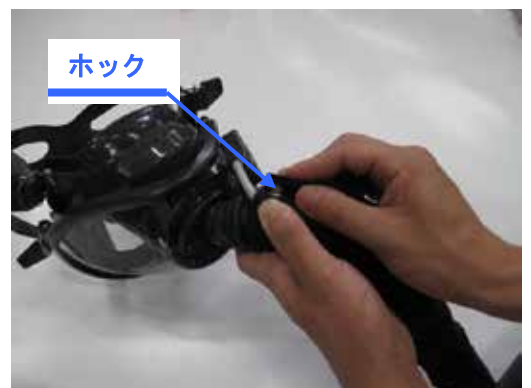
図 4 3. 保護カバー取り付ける
