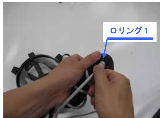
図 3 9. Oリング1にケーブルを通す
