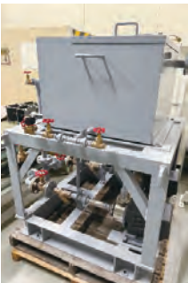
循環式給水ユニット
