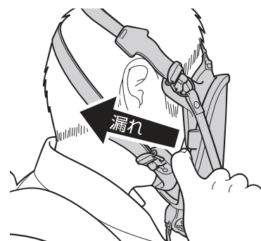
図 37 面体の気密の確認
