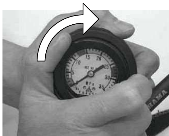
第14図 (レンズカバーの増し締め)
