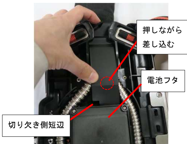
図 7-1. 電池フタに引っ掛ける
