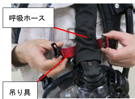
図 35-1 吊り具の取り付け
