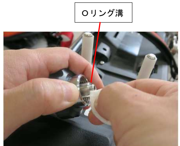
図 54. オリング溝の清掃
