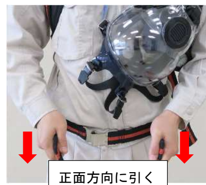
図 39. 腰ベルトを締める
