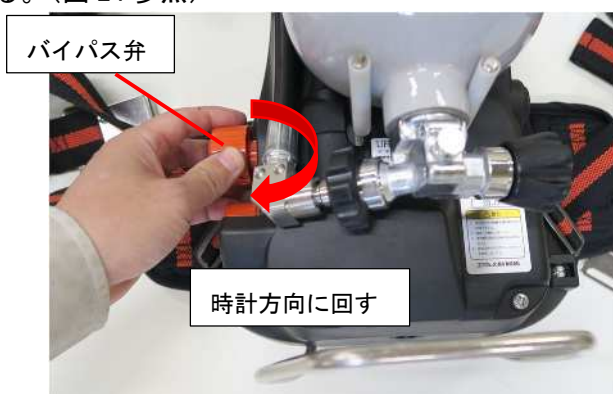
図 24. バイパス弁確認
