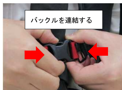
図 35-2 吊り具の接続
