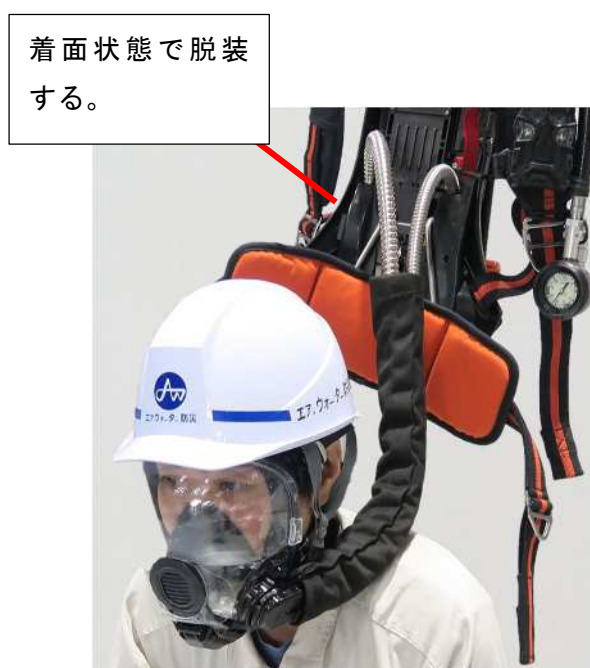
図 49. 着面状態での脱装
