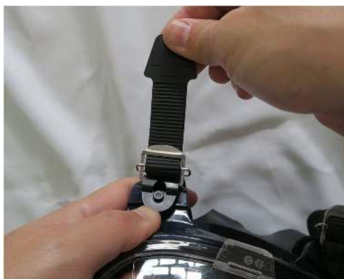
図 63. しめひもを外す(頭頂部 2 箇所)
