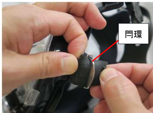
図 62. しめひもを外す(左右 4 箇所所)
