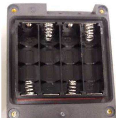
図 4-3. 電池取り付け部
