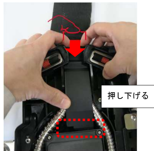
図 7-2. 立坑進入キーを押し下げる
